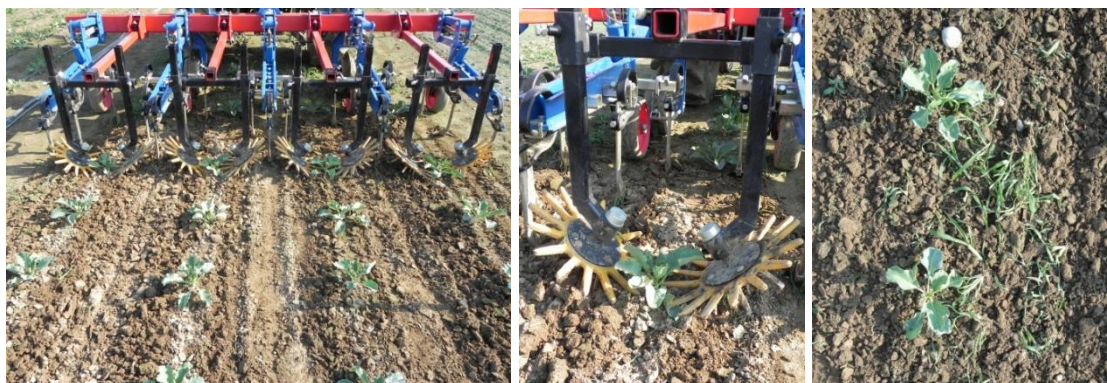
Slika 6: Prstasti okopalnik, ki smo ga uporabili v letu 2019 omogoča natančno in učinkovito delo (levo; sredina) in viden učinek po prehodu z okopalnikom (desno)
