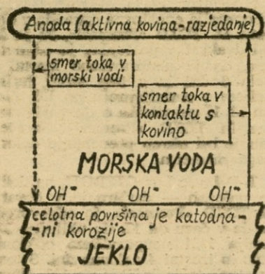
Slika: KATODNA ZAŠČITA JEKLA V MORSKI VODI (primer a. + b.)
