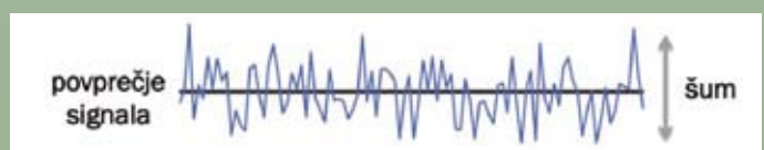
Slika 6: Osnovni signal na sliki (označen z ravno črto), pošumljeni signal; razmerje SNR se izračuna kot kvocient standardnega odklona šuma in povprečja signala.
