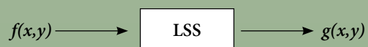
Slika 1: Slikovni sistem, kot linearni stacionarni sistem, ki vhodni signal f(x,y) pretvori v izhodno sliko g(x,y)
