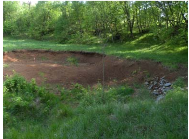
Slika 116 Vrtača št. 4. Večji kosi apnenca na stiku s skalno podlago na zahodnem pobočju izkopa.
