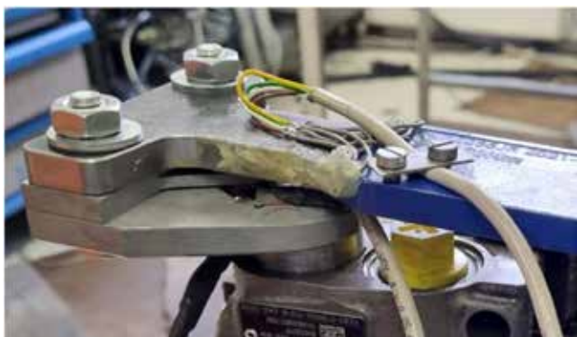
Slika 7 : Merilni lističi na momentnem ključu (Vir: Po-clain Hydraulics)
