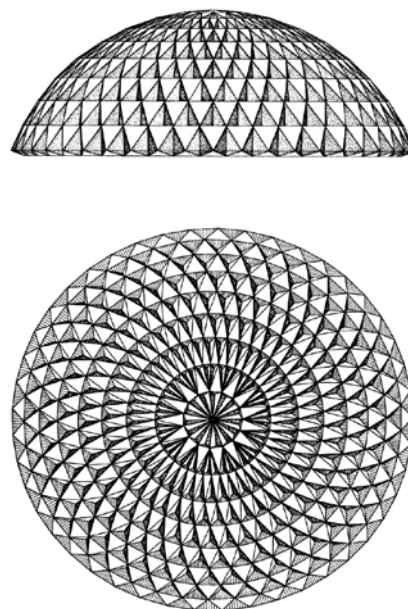
Slika 1: Horizontalni in vertikalni pogled na sferično obliko primerno oblikovane steklene prostorske konstrukcije.
