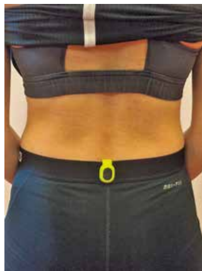
Slika 1. Namestitev senzorja Garmin Running Dynamics Pod na spodnji ledveni del trupa
