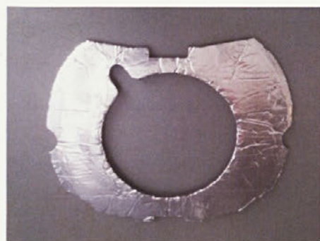
Preko aluminijastel folije se električni naboj (statika) odvede v električno omrežje
