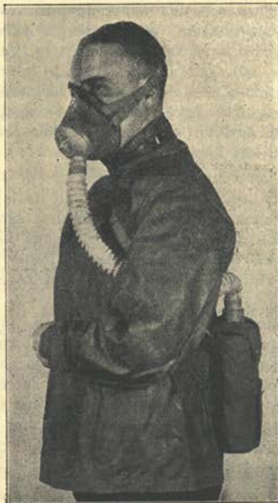
Plinska maska, ki ima veliko cedilo. To je pritrjeno zavarovancu na hrbtu.
