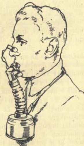
Plinska maska, ki ne zakrije obraza in oči. Spona zatisne nosnice, da človek diha samo skozi usta.
