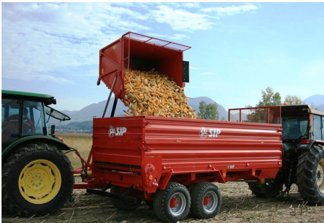
Slika 10: Praznjenje zalogovnika obiralnika koruze v storžih, transport storžev se opravlja s standardnimi traktorskimi prikolicami s povišanimi stranicami
