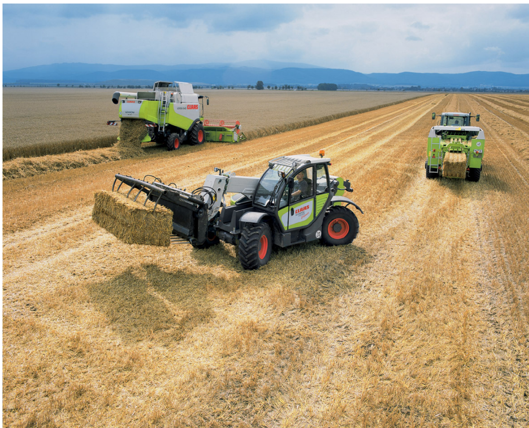
Slika 36: Linija za spravilo velikih kvadrastih bal, žetvene ostanke, ki nastanejo po spravilu žita s kombajnom pobere stiskalnica za velike kvadraste bale, za nakladanje bal je namenjen dvoriščni traktor s teleskopsko nakladalno roko, kvadraste bale se nakladajo na posebne izvedbe prikolic za prevoz kvadrastih bal.
