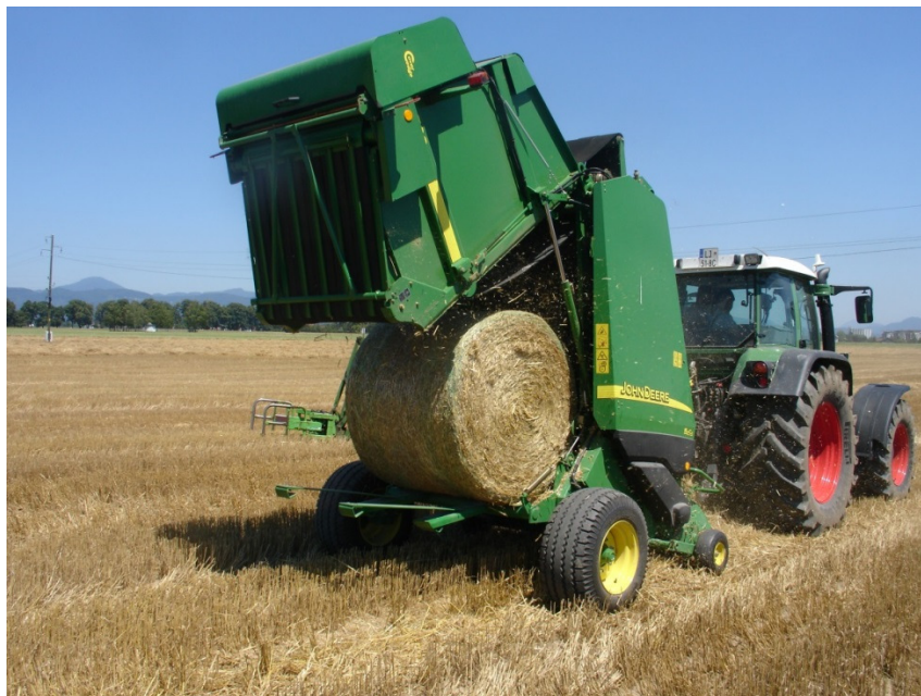
Slika 29: Za pobiranje slame in koruznice in stiskanje oziroma izdelavo suhih bal za zmanjševanje prostornine žetvenih ostankov za energetske namene se lahko uporabljajo obstoječe stiskalnice za valjaste bale, ki so razširjene v slovenskem kmetijskem prostoru
