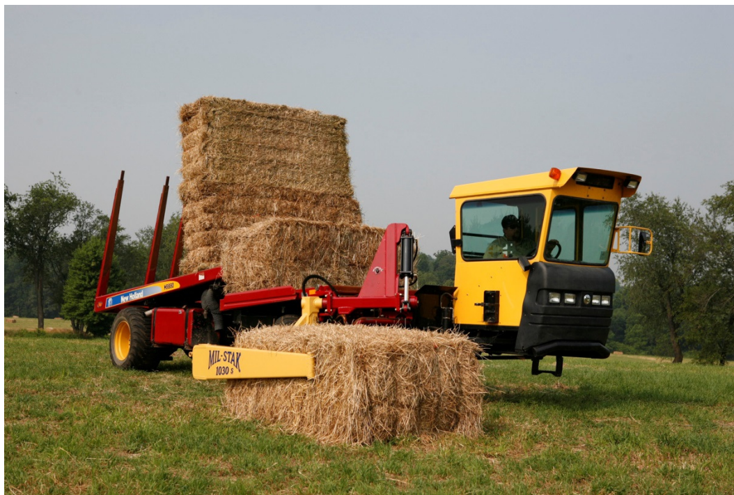
Slika 31: Transporter za pobiranje kvadrastih bal iz žetvenih ostankov (vir: New Holland)
