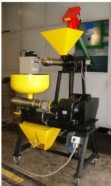
Slika 38: Dvofazna mehanska ekstrakcija olja v laboratorijski mikro oljarni, Laboratorij za kmetijsko strojništvo, Jable
