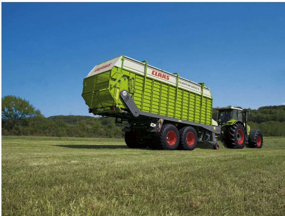
Slika 32: Samonakladalna prikolica velike prostornine (40 m 3 ) za traktorje moči do 130 kW
