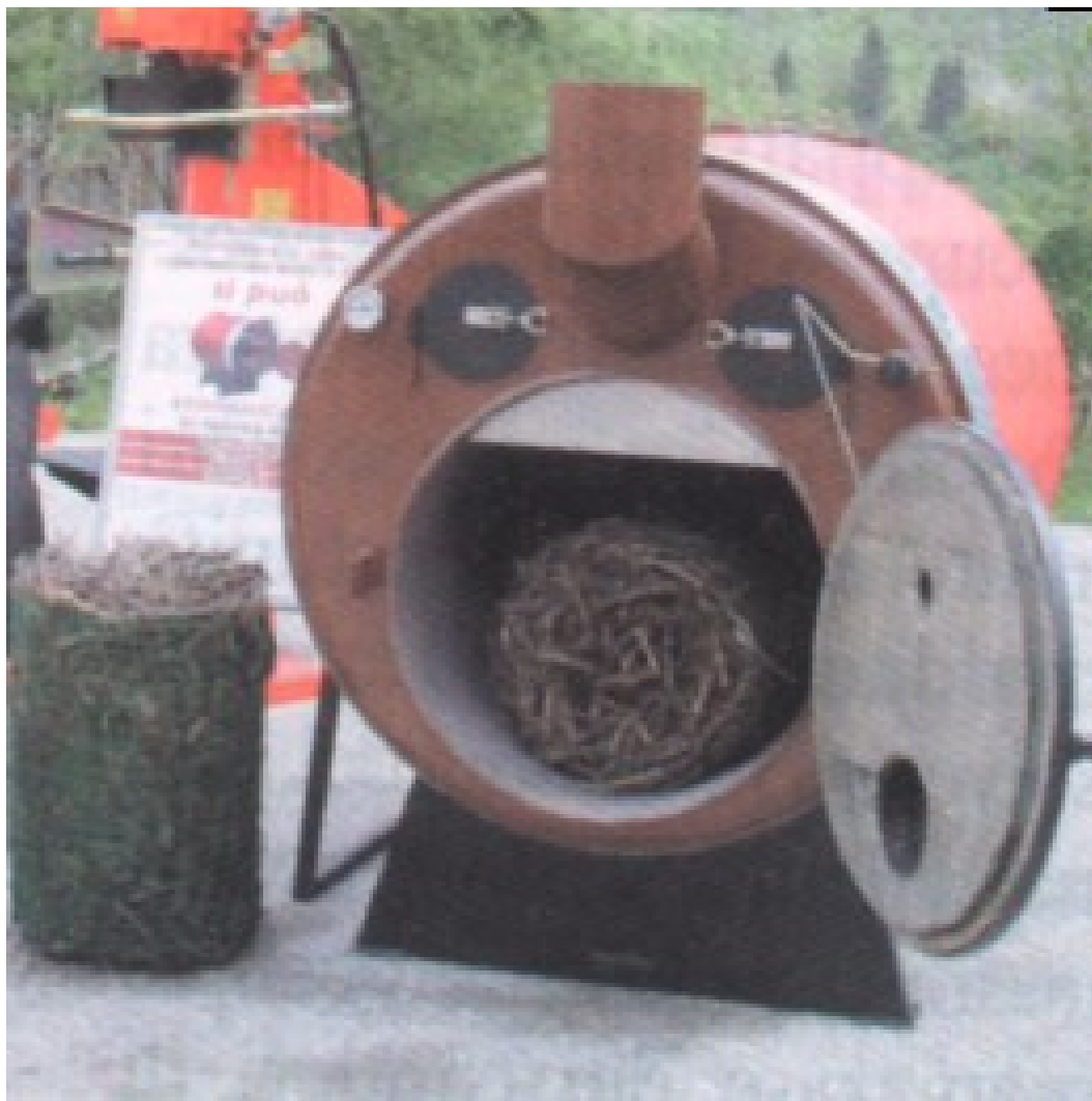
Slika 22: Posebna izvedba kotla za sežiganje valjastih bal iz različnega rastlinskega materiala, podobni kotli so namenjeni za sežiganje velikih bal iz slame ali koruznice
