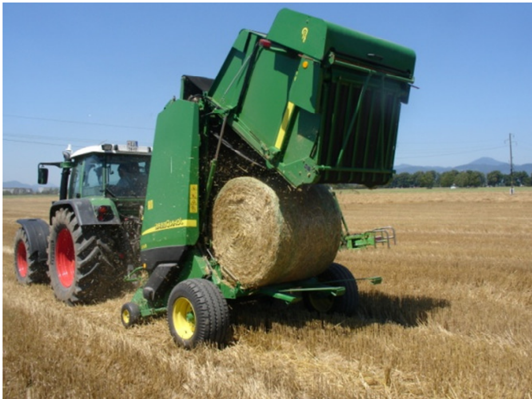
Slika 5: Za pobiranje slame in koruznice in stiskanje oziroma izdelavo suhih bal za zmanjševanje prostornine žetvenih ostankov za energetske namene se lahko uporabljajo obstoječe stiskalnice za valjaste bale, ki so razširjene v slovenskem kmetijskem prostoru.
