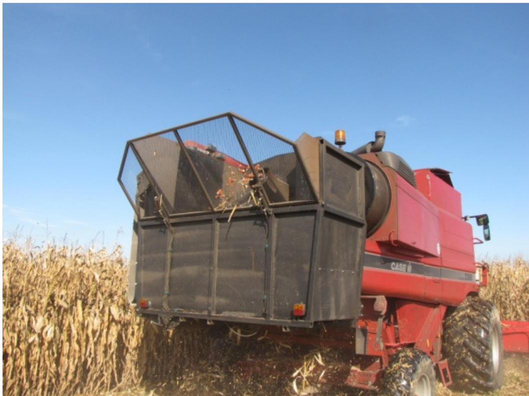
Slika 19: Kombajn za spravilo koruznega zrnja z aksialnim rotorjem ter dodatnim sklopom za zajem klasincev
