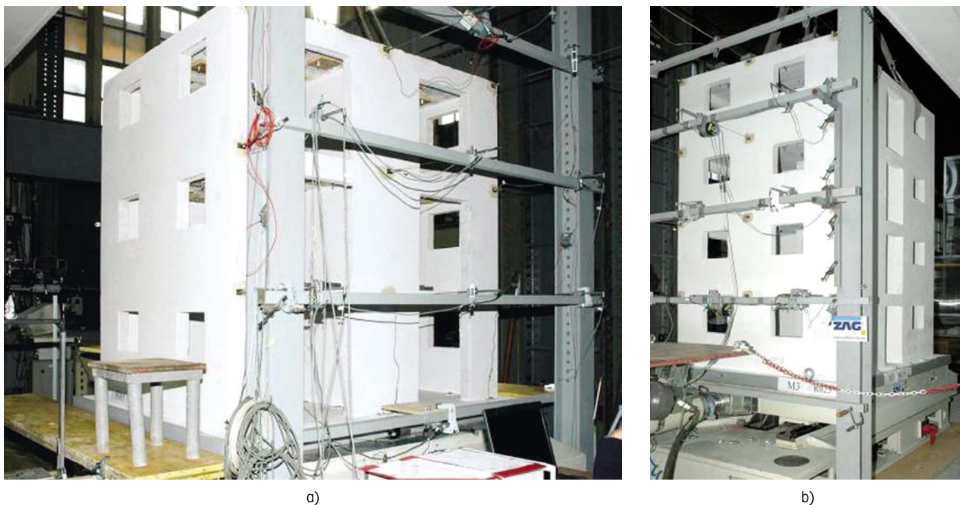
Slika 13 • Postavitev modelov na potresno mizo in način pritrditve merilnih instrumentov a) model M1; b) model M3
