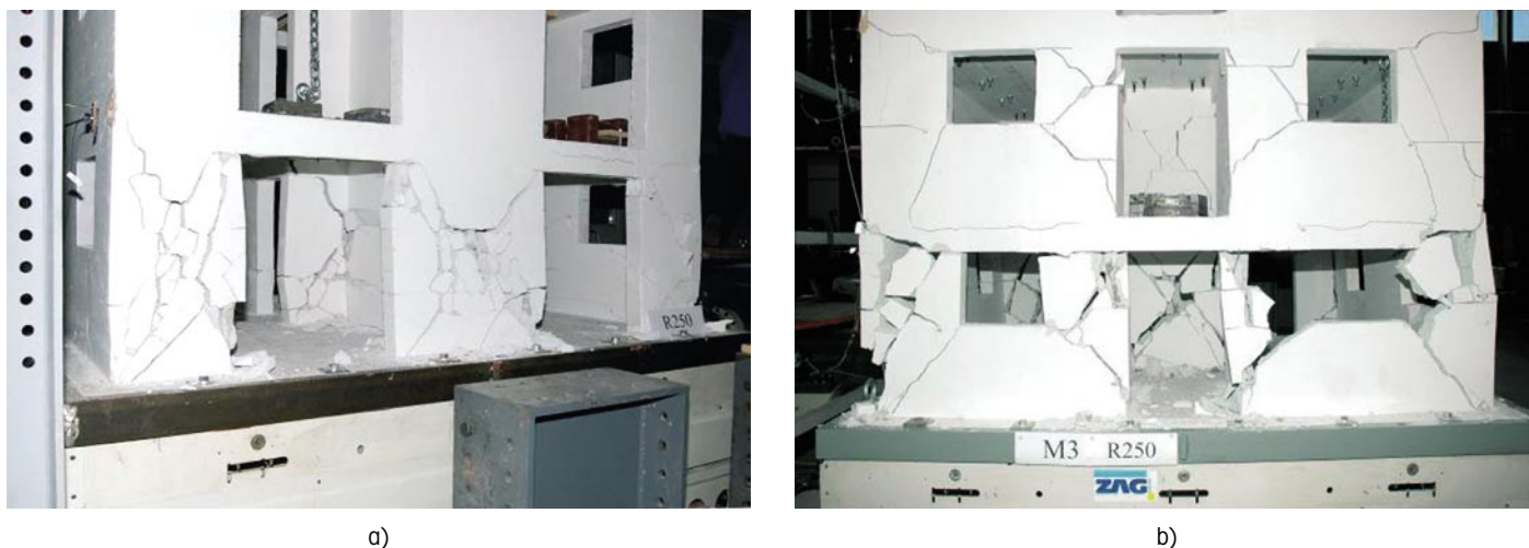
Slika 14 • Tipične poškodbe zidov modelov pri mejnem stanju porušitve a) model M2; b) model M3; parapeti niso poškodovani
