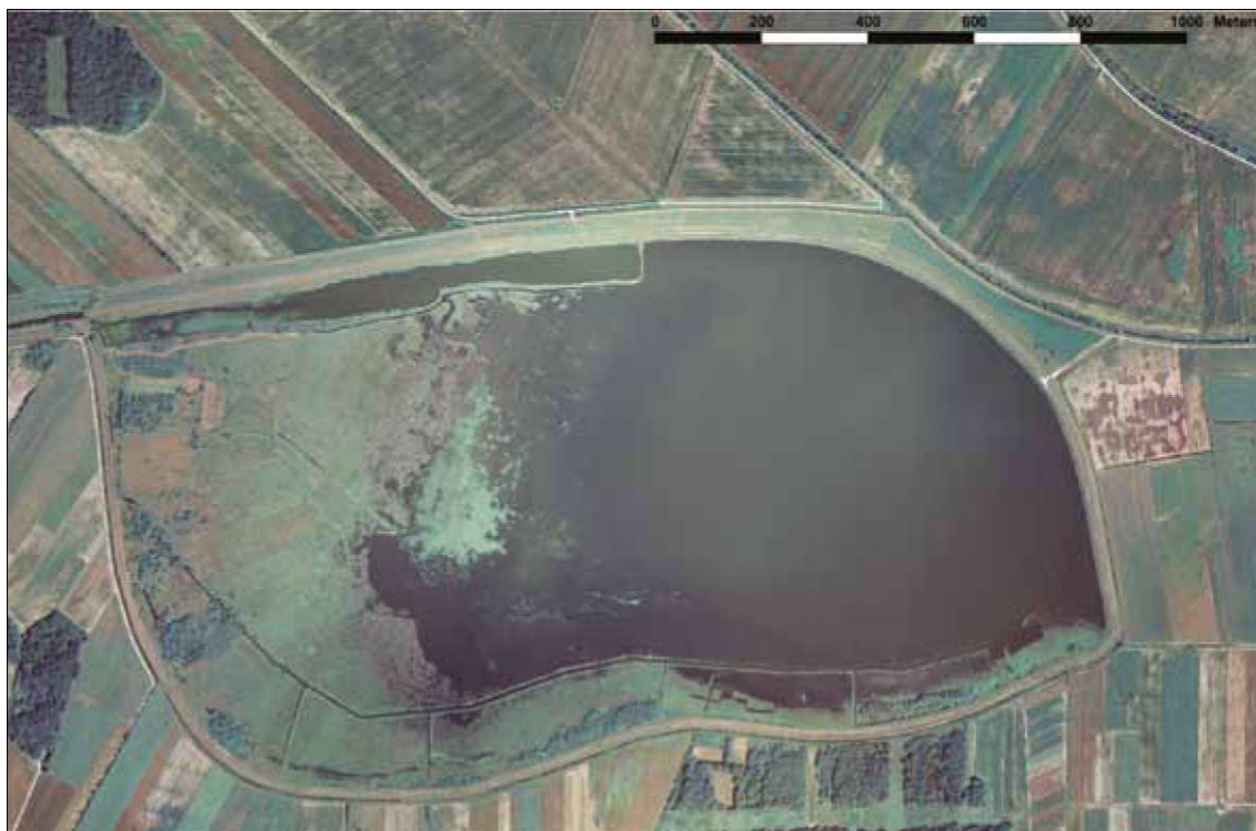
Slika 2: Ortofoto zadrževalnika Medvedce, julij 2006 (© Geodetska uprava Republike Slovenije). Zadrževalnik obdaja visokovodni nasip, vodni in kopenski del zadrževalnika sta ločena s 50-200 m širokim pasom rogoza Typha sp. in navadnega trsta Phragmites australis . Na SZ vogalu se v zadrževalnik steka dovodni kanal, ki se nadaljuje v širši notranji kanal. V začetnem delu notranjega kanala in ob zahodnem robu odprte vodne površine je viden pas zakoreninjenih plavajočih makrofitor. Vzdolž severnega in vzhodnega roba zadrževalnika se na zunanji strani nasipa raztezajo občasno poplavljeni travniki.
