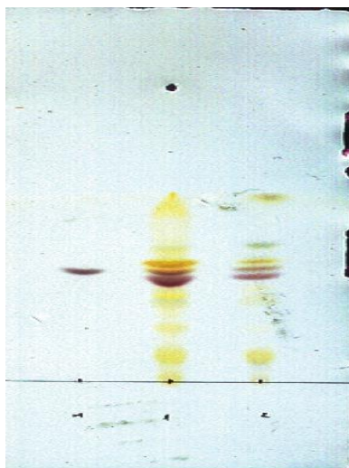
Slika 1: Kromatogram vzorca v metanolu rdeče barve s standardom hipericina.
