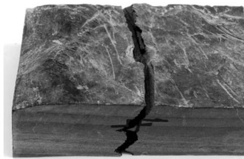
Sl. 17. Prelom v laminiranem do tanko plastovitem menjavanju glinastega skrilavca in peščenega metameljevca pri obremenitvi pravokotno na  $s_0$  in  $s_1$ . Vzorec 4/1. Dolžina spodnjega roba vzorca je 53 mm.
