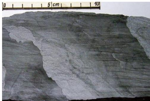
Sl. 2. Menjavanje tankih plasti glinastega skrilavca in peščenega metameljevca z navzkrižno plastovitostjo in s prečno (horizontalno) potekajočo s<sub>1</sub>. Šentviški hrib, stacionaža 1409.
