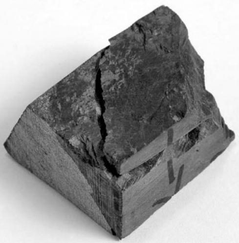
Sl. 13. Porušitev glinastega skrilavca in skrilavega meljevca in filosilikatnimi laminami pri obremenitvi vzdolž  $s_1$ . Vzorec 5. Dolžina spodnjega desnega roba vzorca je 35 mm.
