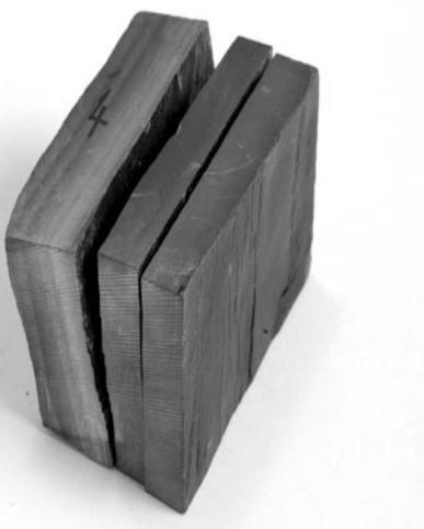
Sl. 18. Prelom v laminiranem do tanko plastovitem menjavanju glinastega skrilavca in peščenega meta-meljevca pri obremenitvi vz dolž  $s_0$  in  $s_1$ . Vzorec 4. Dolžina spodnjega roba vzorca je 35 mm.
