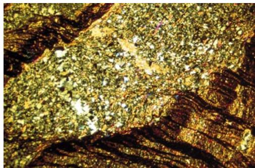
Sl. 6. V glinastih laminah se je razvil plisiran klivaž s koncentracijo grafitizirane organske materije vzdolž sekundarne skrilavosti. Poteka prečno na peščeno meljasto plast, v kateri se deformacija odraža kot ekstenzijske mikrožilice. + N, povečava 15 ×.
