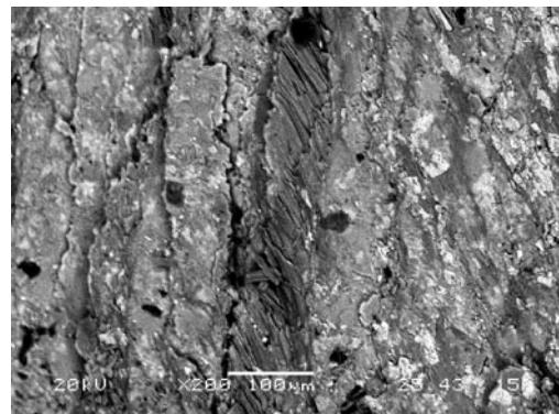
Sl. 12. Pri povišanih usmerjenih pritiskih so se vzdolž drsnih ravnin koncentrirali lepidoblasti sericita (vertikalni trak v sredini slike).
