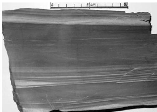
Sl. 1. Laminirano do tanko plastovito menjavanje glinastega skrilavca in peščenega meta-meljevca z rahlim reverznim zamikom desno spodaj. Sentviški hrib, stacionaža 1404.
