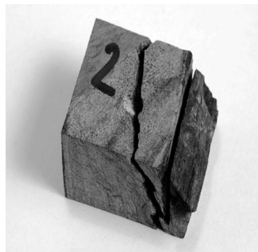
Sl. 16. Tanka plast peščenega metameljevca z drobno nagubanimi filosilikatnimi laminami vzdolž navzkrižne plastovitosti. Prečno na plastovitost je po temenih gubic razvita sekundarna skrilavost. Vzorec 2. Dolžina spodnjega roba vzorca je 35 mm.
