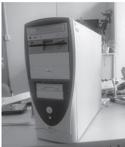
Slika 1: Računalnik z vgrajeno 5,25" in 3,5" disketno enoto, CD pogonom, 80 GB trdim diskom in USB vhodi
