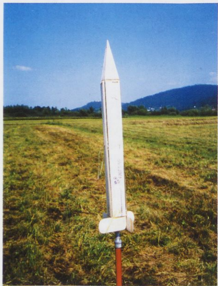
Ena od možnih konstrukcij modela nove kategorije S9B – žirokopterji je t. i. »hišica«. Njena posebnost je, da trup rakete tvorijo kar pristajalni rotorji.
