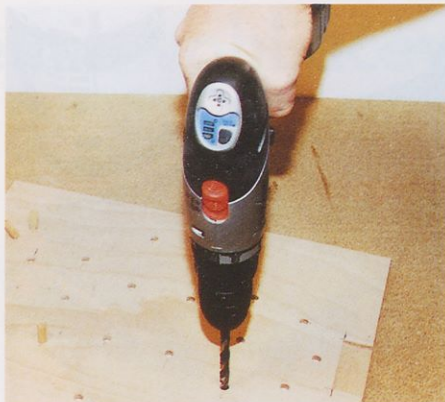
Slika 6. Vrtanje lukenj z akumulatorskim vrtalnikom/vijačnikom HP 12 K; na vrhu ohišja sta dobro vidna elektronska libela in indikator napolnjenosti akumulatorske baterije.
