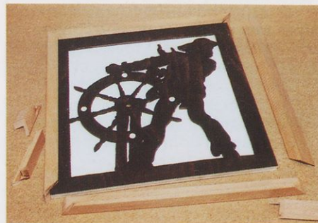
Slika 8. Okvir je narejen iz bukovih letvic s prerezom 20 x 30 mm.
