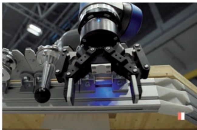
△ Lahki robot DLR pri menjavi obdelovalnega orodja.
