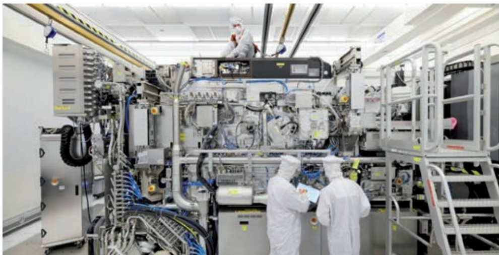
◀ ASML NX3400 za proizvodnjo čipov v 5 nm. Slika: ASML
