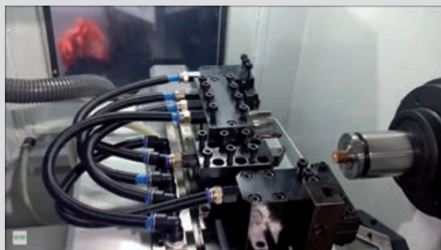
△ Samodejna stružnica za kovino z izmenljivimi obdelovalnimi orodji.
