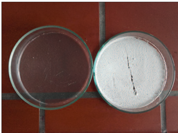
Slika 8. Primerjava raz na filmu PLA z 10 % dodatkom A_NFC (levo) in na filmu PLA z 10 % dodatkom NFC (desno).
