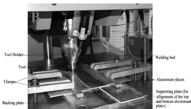
Figure 3: Experimental weld setup of FSW platform Slika 3: Eksperimentalna postavitev FSW platforme za varjenje
