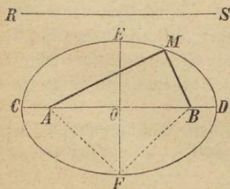
§. 109. Es seien in einer Geraden zwei Punkte A und B (Fig. 88) gegeben. Befestigt man in A und B Stifte und legt um dieselben einen an den Enden zusammen gebundenen Faden, der um die gegebene Strecke RS länger ist als der Abstand AB der beiden Punkte A und B, spannt sodann den Faden mittelst eines Zeichenstiftes M und führt
