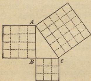
Centimeter auf, und verbinde die Endpunkte durch eine Strecke AC; die Hypotenuse des dadurch entstehenden Dreieckes wird genau 5 Centimeter enthalten. Das Quadrat von 3 ist 9, das Quadrat von 4 ist 16, und die Summe der Quadrate 25; das Quadrat der Hypotenuse 5 ist auch 25. Es ist also das Quadrat der Hypotenuse so groß, als die Summe aus den Quadraten der
