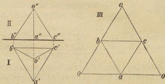
Fig. 162 I ist der Grundriß, II der Aufriß, III das Netz eines Tetraeders.
