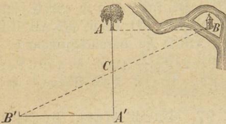
Man errichte in dem zugänglichen Punkte A (Fig. 58) mittelst des Winkelkreuzes auf AB eine Senkrechte AA', wähle darin einen Punkt C, von dem aus man nach B sehen kann, und mache  $CA' = CA$ , sodann errichte man in A' auf AA' eine Senkrechte, und suche darin denjenigen Punkt B', welcher mit B und C in einer geraden Linie liegt. Wird nun A'B' gemessen, so gibt die gefundene Länge (wegen der Congruenz der Dreiecke ABC und A'B'C) zugleich die gesuchte Entfernung AB an.
