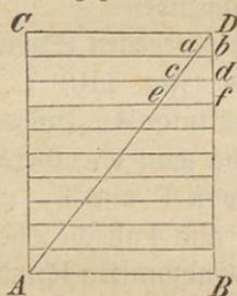
Construction undeutlich erscheinen würden, so wende man folgendes Verfahren an: Man errichte auf AB in den Endpunkten die Senkrechten AC und BD, trage auf jede 10 gleiche große Theile bis C und D auf und ziehe durch je zwei zusammengehörige Theilungspunkte eine Gerade. Zieht man nun die Transversale AD, so ist ab der 10te Theil von AB, cd ist  $\frac{2}{10}$ , ef  $\frac{3}{10}$  u. s. w. von der Strecke AB.
