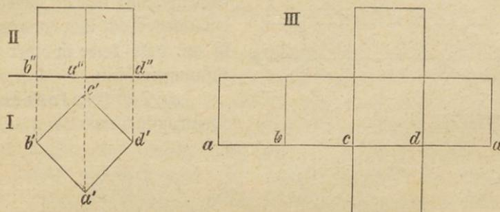
Fig. 163 I stellt den Grundriß, II den Aufriß, III das Netz eines Würfels dar.
