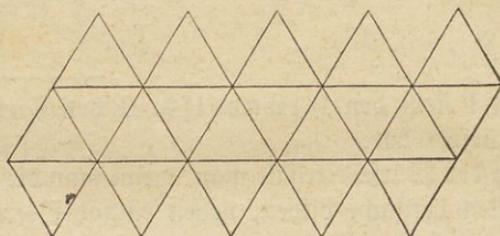
Das Netz eines Icosaeders (Fig. 166) erhält man, wenn man auf eine Gerade die Kante des Icosaeders 5mal aufträgt, über diesen Strecken nach oben und unten gleichzeitige Dreiecke construirt, dann alle Scheitel auf einer Seite durch eine Strecke verbindet, und längs derselben, nachdem sie verlängert wird, wieder gleichzeitige Dreiecke zeichnet, so daß ihrer auf jeder Seite fünf erscheinen.
