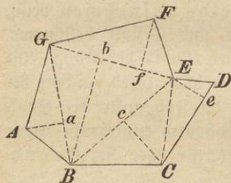
einem verzüngten Maßstabe aufträgt. Die dadurch erhaltenen Punkte haben dieselbe Lage gegen einander, wie die entsprechenden Punkte auf dem Felde; man braucht sie nur noch gehörig durch Linien zu verbinden. In Fig. 141 würde man mit dem Dreiecke ABG beginnen und dann folgeweise die Dreiecke BGE, GEF, BEC, CED construieren.
