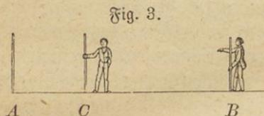
dieses der Fall, so gibt man dem Gehilfen ein Zeichen, worauf er den Stab frei fallen lässt und in dieser Stellung in die Erde steckt. — Beim Abstecken einer langen Linie werden immer die entfernteren Stäbe früher eingerichtet, als die näheren.
