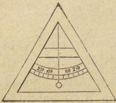
vertical: soll die Grundlinie, und die darunter befindliche Gerade horizontal sein, so muß sie auf den verticalen Faden senkrecht stehen: dies ist aber der Fall, wenn der Faden genau in die Mitte fällt.
