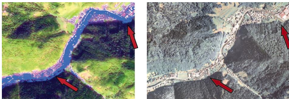
Slika 14: Poplavljene površine pod gozdom. S puščico so označena mesta uspešno prepoznanega robu poplavljenega območja na mestih prekritih z gozdom (prikaz na večspektralnem satelitskem posnetku SPOT - levo oz. letalskem posnetku DOF - desno).
