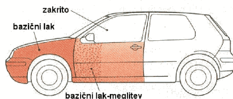
Slika 2: Zadnja faza brizganja bazičnega laka in megljenje sosednjega dela
