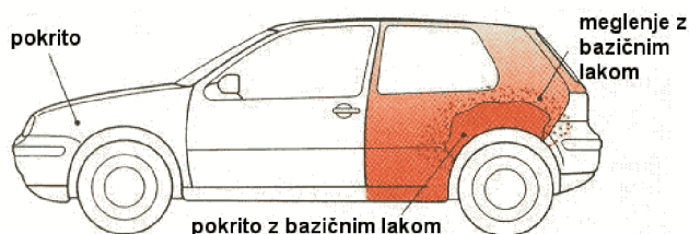
Slika 7: Megljenje z bazičnim lakom
