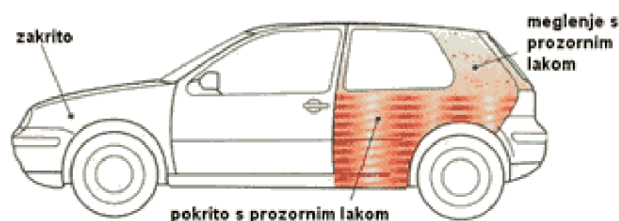
Slika 8: Brezbarvni (prozorni) lak z iztekom lakirati na prehod
