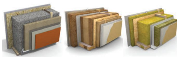
Slika 4: Stenski elementi pasivnih hiš, od leve proti desni: lesena okvirna konstrukcija z I-profilimi in toplotno izolacijo iz celuloznih vlaken (Sistem Lumar IG); panelni konstrukcijski sistem s toplotno izolacijo iz lesnih vlaken (sistem Marles hiše Maribor); panelni konstrukcijski sistem s toplotno izolacijo iz mineralne volne (sistem Marles hiše Maribor).
