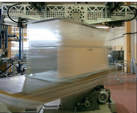
Slika 7. Vrtenje in preprijevanje požarnih loput
