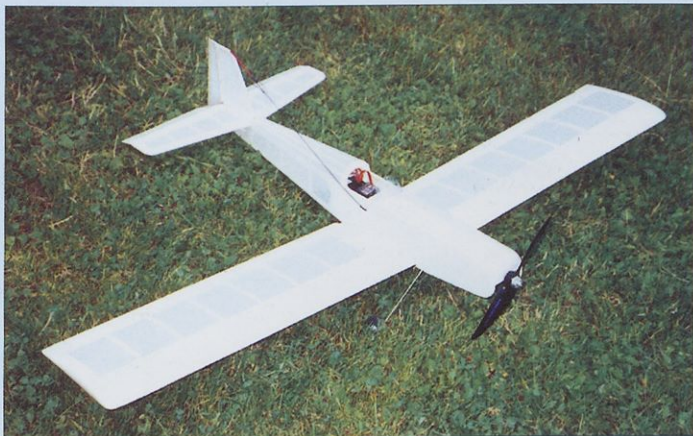
Slika 8. Zaradi majhnih koles in omejene moči pogona vzletanje s travnate površine ni mogoče.
