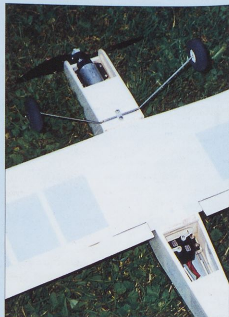
Slika 7. Odprtina na spodnjem delu trupa omogoča dostop do servomehanizmov, poleg tega skozi izteka tudi hladilni zrak.
