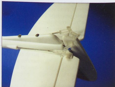
Repne površine so pritrjene z dvema vijakoma. Priključiti moramo še krmilne ročice in nastaviti njihovo srednjo lego.
