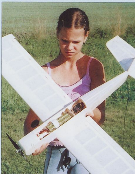
Slika 10. Velik pokrov trupa omogoča hiter in enostaven dostop do pogonske baterije.
