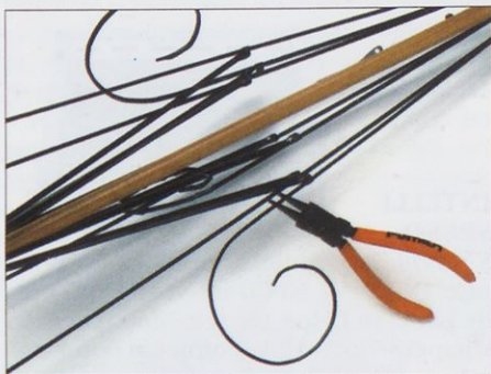
Slika 1. Kovinske palice z okroglimi kleščami zavijajte izmenično navzgor in navzdol.
