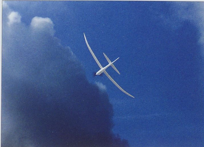
Eliptični V-lom zagotavlja stabilnost v letu.
