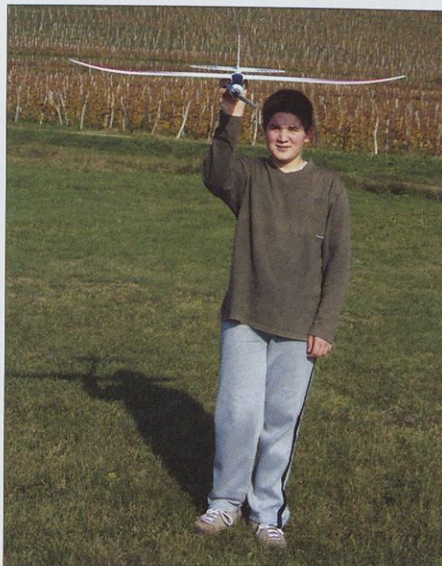
Ob metu modela v zrak naj bodo krila vodoravna in nos modela rahlo povešen.
