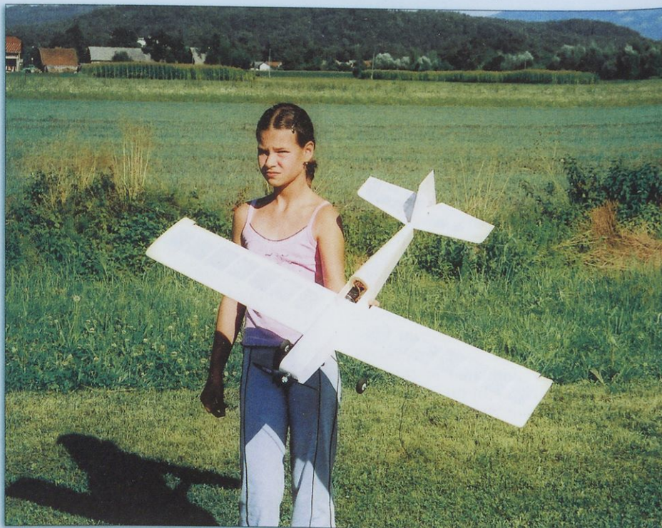
Slika 1. Orion ni ravno tipičen »park flyer«, saj je krmiljen okoli vseh treh osi.
