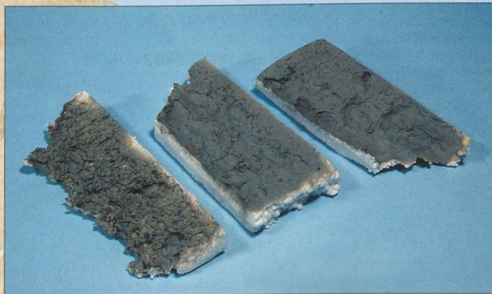
Stiropor, obdelan z univerzalnim lepilom (desno in v sredini) ter s čistilom za čopiče (levo)
