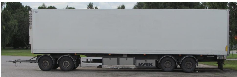
Slika 62: Priklopnik z vrtljivim ojesom z dvoosnim podpornim vozičkom
