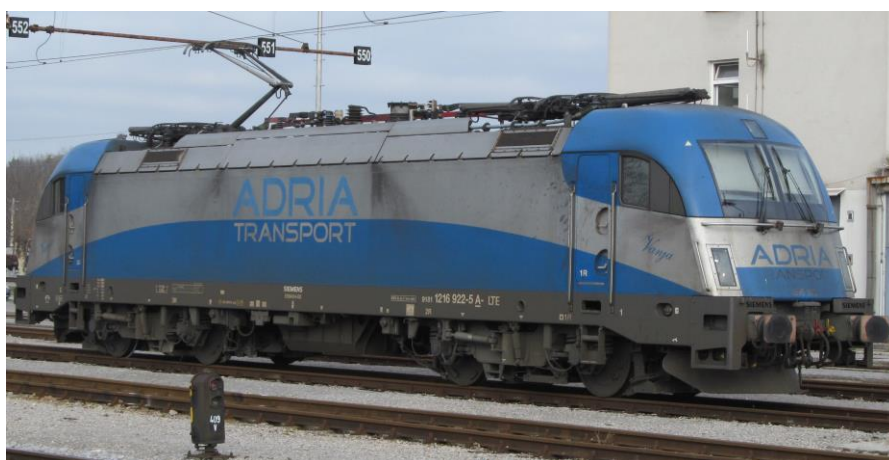
Slika 103: Večsistemska električna lokomotiva Siemens ES64U4
