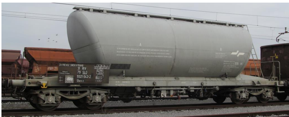
Slika 114: Vagon z vsebnikom za prevoz snovi v prahu (podserija Uacs-z)
