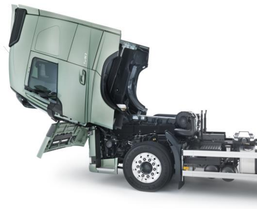
Slika 40: Preključljiva kabina za dostop do motorja (slika: © Volvo Trucks)
