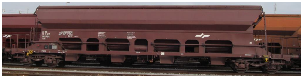
Slika 112: Štiriosni zaprti vagon za prevoz razsutega tovora z gravitacijskim praznjenjem (podserija Tadds-z)
