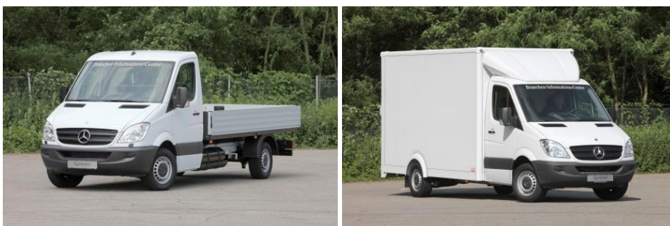
Slika 22: Lahki tovorni vozili z nadgradnjama BA in BB (sliki: © Daimler AG)
