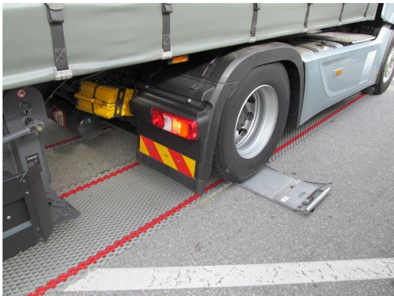
Slika 80: Tehtanje osne obremenitve vozila na prenosni tehtnici
