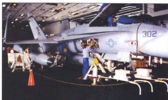
Vzdrževanje letal poteka v hangarjih globoko v notranjosti letalonosilke, če pa je treba, letalo pregledajo in odpravijo manjše napake kar na vzletni ploščadi.
