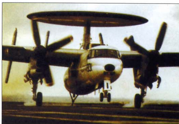
Letalonosilke imajo na krovu letala E 2 hawkeye s sistemom za zgodnje opozarjanje, to je z radarjem dolgega dosega, ki zazna nasprotnika, čeprav je ta oddaljen od letalonosilke več kot 500 km. Trije operaterji lahko hkrati spremljajo kar 600 letal.
