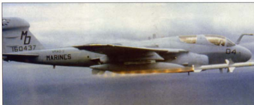
Letala EA 6 B prowler so namenjena elektronskemu bojevanju. Za uničenje protiletalskih baterij so opremljena z izstrelki HARM (Hight Speed Anti radiation Missiles), ki najdejo vir elektronskega sevanja. Na posnetku prowler izstreljuje raketo HARM.
