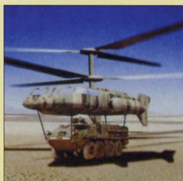
Sikorsky predlaga helikopter, ki bi bil v bistvu leteče dvigalo in bi imel dva rotorja, enega nad drugim, ki bi se vrtela vsak v svojo stran. Foto: Sikorsky
