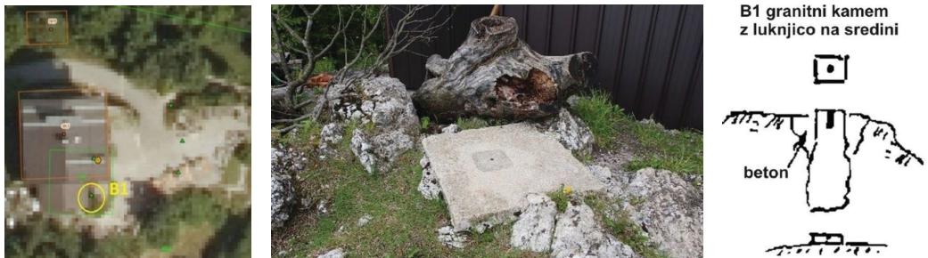
Slika 9: Položaj točke bočnega zavarovanja B1 (vir: PREG), njegov videz (foto: LGD, 1. 6. 2019) in skica njegove stabilizacije (vir: PREG).
