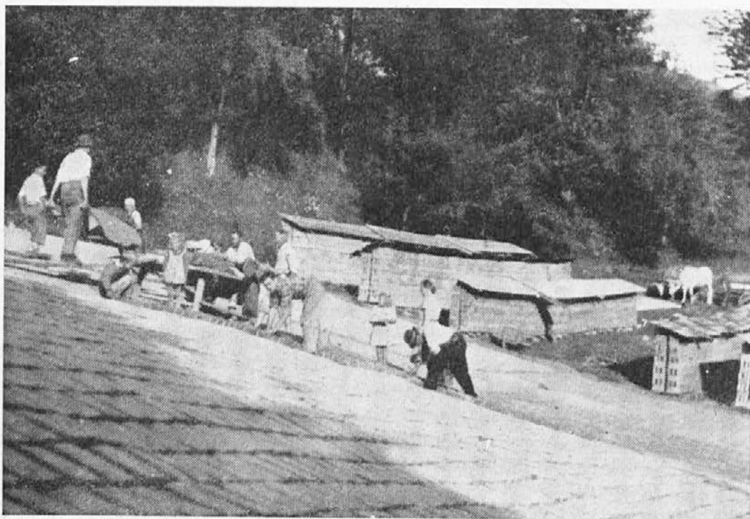
In v nekaj dneh so okrog »štanta« skladi opeke, ki se bo posušila na soncu in bo trden zidak.
