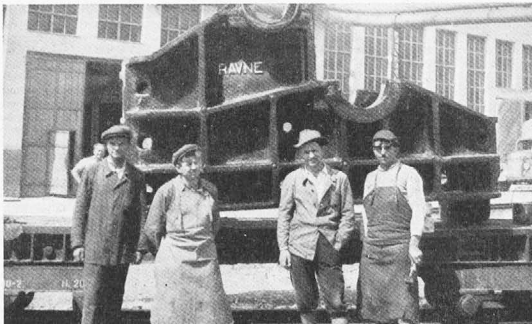
Veliki komplicirani ulitek drobilca je izpadel brezhibno.
