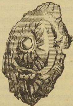
Dem Geschoss-Cylinder geht es noch schlechter als der Spitze: er zerschellt, — und es ist dabei ziemlich gleichgiltig, ob das Brechen des Cylinders durch die Torsions-Inanspruchnahme eingeleitet wird, oder ob er bis zum Zerknicken gestaucht wird; — er bricht, und die Bruchstücke liegen theils nahe vor dem Panzerziele, theils werden sie weit rück- und seitwärts geschleudert, wäh-
