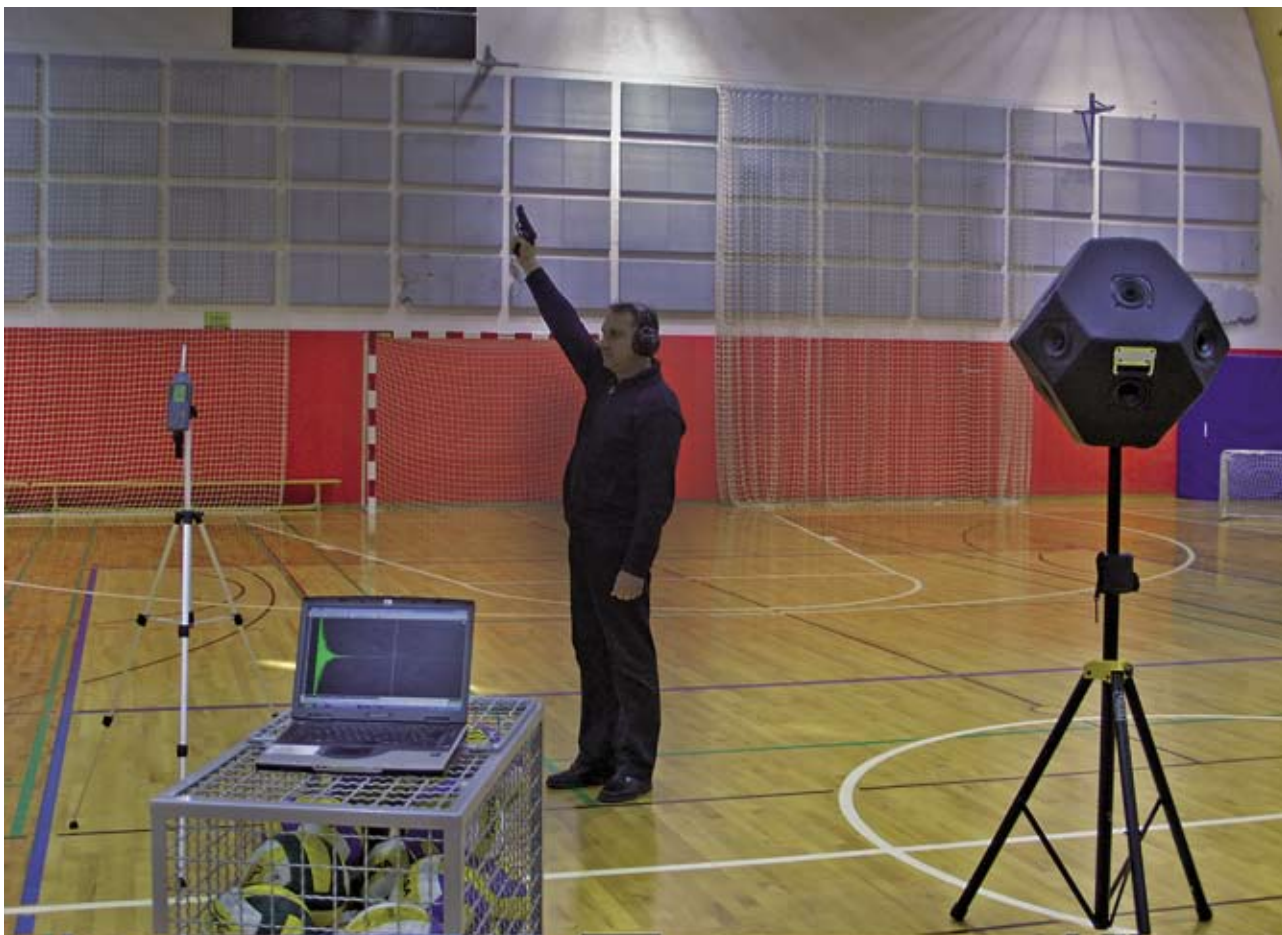
Slika 1: Prikaz merjenja odmevnega časa.
