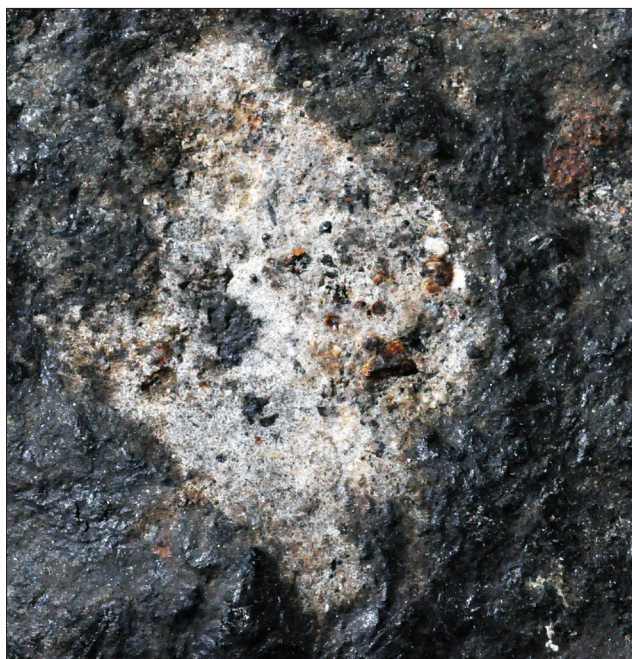
Sl. 4. Drobni kroglasti fragmenti so mestoma obdani z limonitom, kar spominja na hondrule, ki so sicer značilne za kamnite meteorite hondrite. Na tem kosu feromangana so zelo verjetno sekundarnega nastanka, saj so opazni samo na površini, detajl meri 1 x 1 cm.
