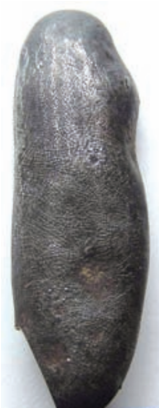
Kapljica na hitro ohlajene nikljevo- železove litine iz žlindre jeseniške železarne; 44 x 18 mm. Foto: Miran Udovč
