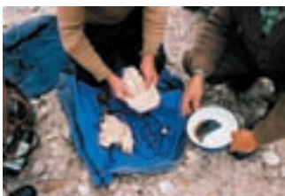
Težkim mineralom z zlatom so v skodelici dodali živo srebro ter z ročnim tresenjem in mešanjem povzročili nastanek amalgama z zlatom.. Foto: Milan Bidovec
