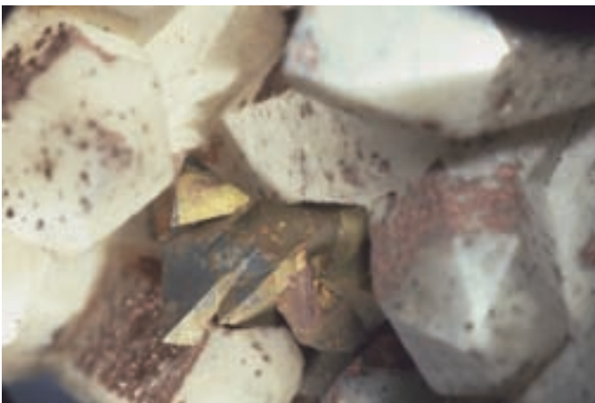
Tetraedrični halkopirit med kristali kremena in albita; izrez 7 x 4 mm. Zbirka Oddelka za geologijo Naravoslovnotehniške fakultete Univerze v Ljubljani. Foto: Miran Udovč
