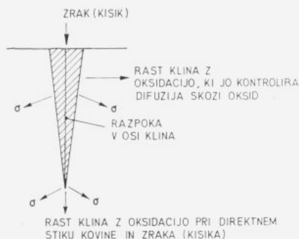
Slika 12: Shema rasti in delovanja oksidnega klina
