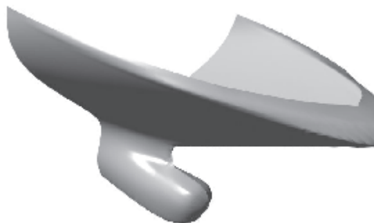
Sl. 2. Ploskev testnega premca z zaobljenim profilom za zmanjšanje trenja Fig. 2. The bow surface of the test hull with the bulb for friction-drag minimisation
