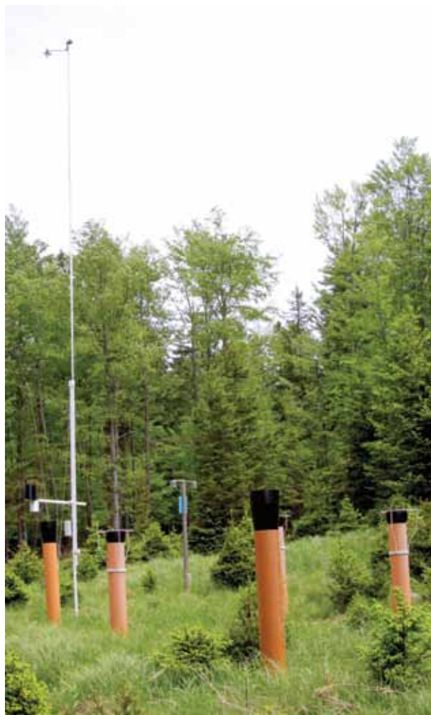
Samodejna vremenska postaja z vzorčevalniki padavin na prostem je postavljena na poseki v bližini Osankarice na Pohorju.
