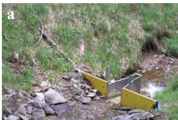
Parshallov preliv za meritve pretoka na Javorskem potoku v zgornjem porečju Oplotnice na Pohorju: a) normalno stanje, b) po poplavih v novembru leta 2012.
