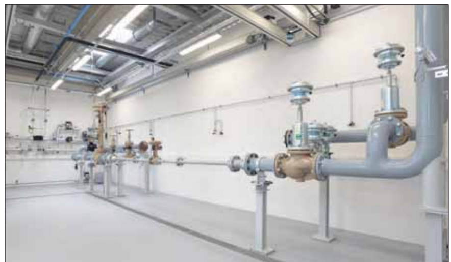
Slika 4. Testna proga za simuliranje realnih procesov z različnimi mediji
