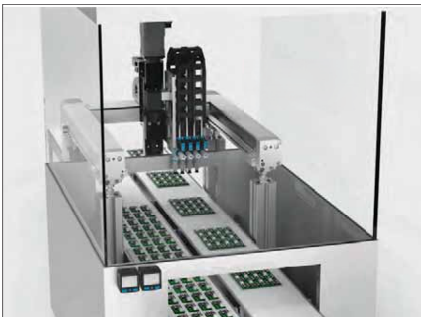
Vgradnja generatorja podtlaka OVEL na strežno napravo
