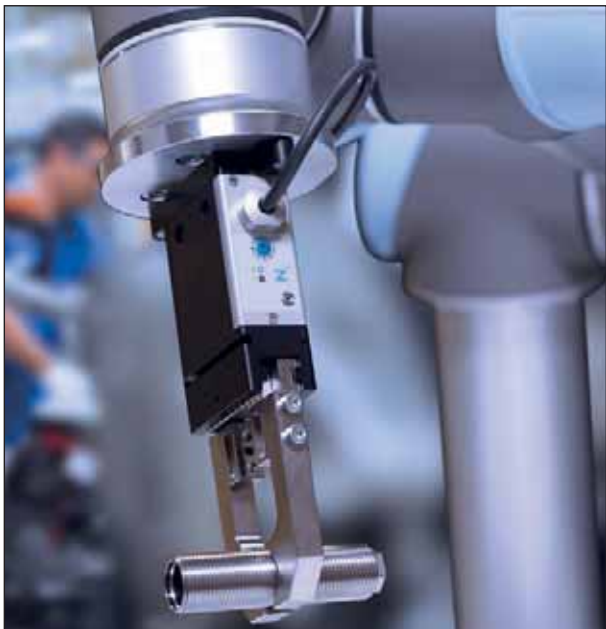
Električno prijemalo pri montaži blažilnikov
