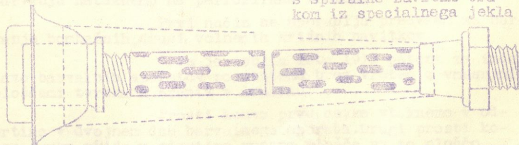
Sl. 70. Vreteno tv. Papst, Aue za stožčasto perforirano cevko 22 x 44 mm
