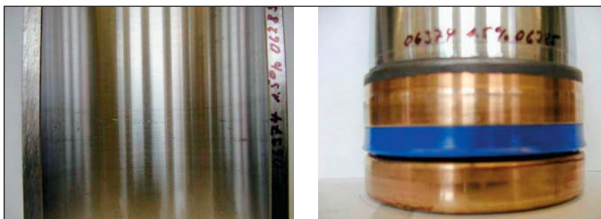
Slika 4. DBT-korozijski test 1,5-odstotne koncentracije Quintolubrica 818-02 v »velenjski« vodi
