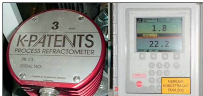
Slika 6. On-line spremljanje koncentracije v Premogovniku Velenje
