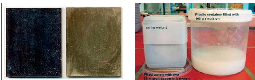
Slika 5. Quaker korozijski test 2-odstotne koncentracije Quintolubrica 818-02 v »velenjski« vodi
