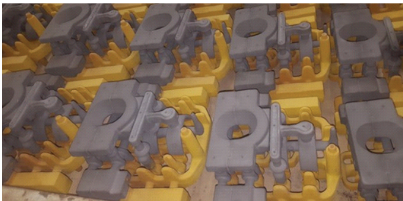
Nova jedrarna: izdelava jeder po Croning postopku
