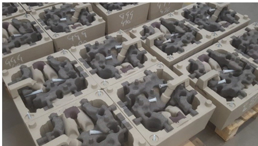
Nova jedrarna: montaža jedrnih paketov iz različnih peščenih mešanic
