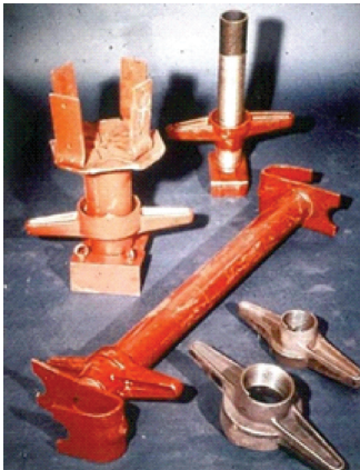
Sl. 11. Deli iz bele temprane litine za izdelavo gradbenih odrov, ki morajo prenesti velike obremenitve do 30 ton, v posebnih primerih do največ 75 ton [20]
