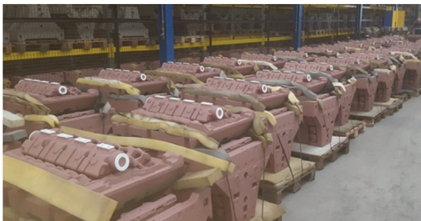
Nova jedrarna: izdelava jeder po Croning postopku
