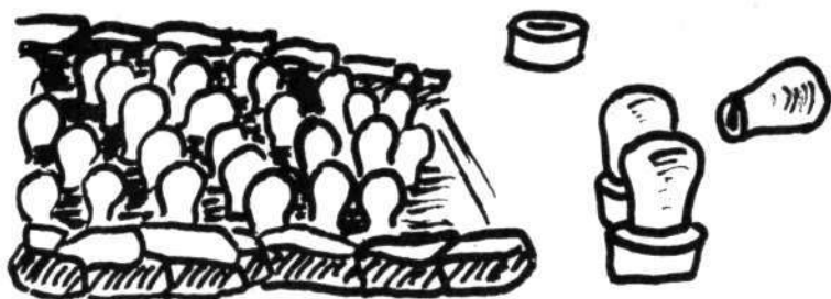
Na levi ograda z vrči, ki so napolnjeni z rudo; na desni podstavek (zgoraj levo), vrč (zgoraj desno) in oba, ko sta zložena skupaj (spodaj).
