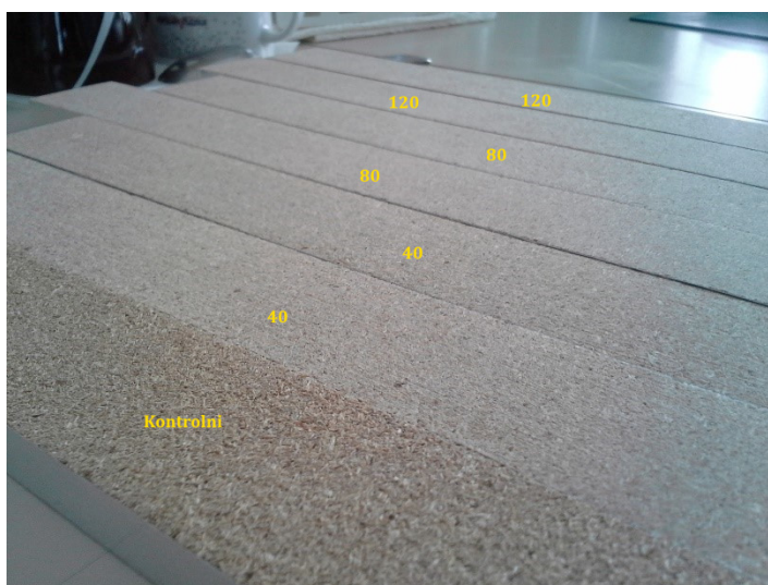
Slika 1: Videz površine preskušancev (spodaj: nebrušen kontrolni preskušavec; 40: brušen z brusnim papirjem zrnatosti 40; 80: brušen z brusnim papirjem zrnatosti 80; in 120: brušen z brusnim papirjem zrnatosti 120)
