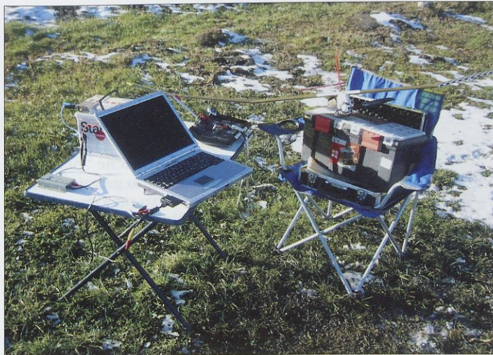
Brezžični videosistem na terenu. Sliko iz modela prejme sprejemnik in jo posreduje računalniku.
