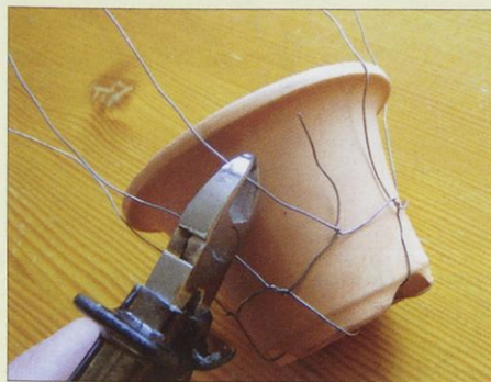
Slika 6. Odvečna konca prečne žice porežite s ščipalnimi kleščami na 4 cm.
