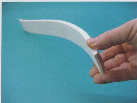
Lamelirana balza po snetju s kalupa
