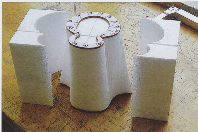
Izrezovanje dela trupa z vstopnikom za zrak
