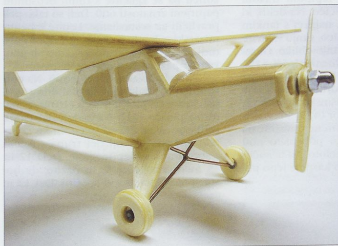
Zasteklitev kabine prilepite s prozornim kontaktnim lepilom.
