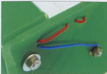
Slika 15. Luknjice za povezavo vodnikov izvrtamo od spodaj s svedrom premera 2 mm; položaj izberemo sami.
