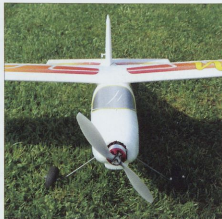
Z brezkrtačnim pogonom lahko minimag poleti celo s trave.
