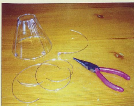
Slika 26. Ščipanje in polžasto zvijanje koncev debelejšje žice
