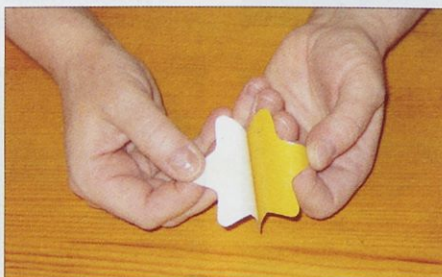
Slika 5. Odstranjevanje ene plasti zaščitnega papirja
