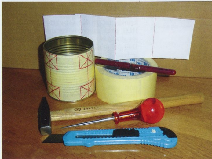
Oblepljena konzerva z vrisanimi odprtinami in orodjem za izrezovanje odprtín
