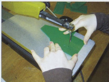
Slika 1. Razrez akrilnega stekla z električno rezljačo
