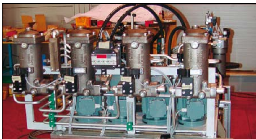
Slika 11. Napajalne črpalke s tlačnimi filtri
