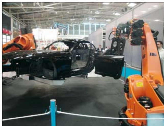
Montaža vrat, šasijo drži robot (vir: Noe)
