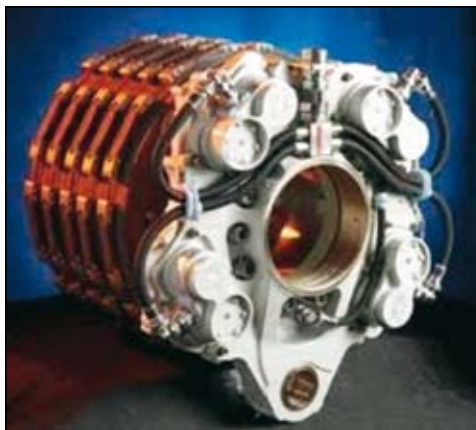
Slika 4. Električna zavora in njena namestitvev (proizvajalec Goodrich)
