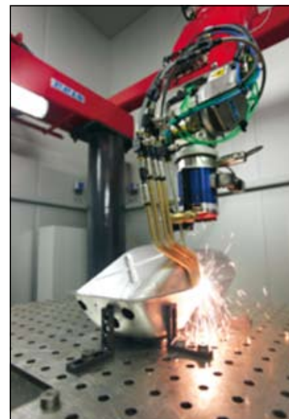
Robotizirano obrezovanje (vir: Reis Robotics)
