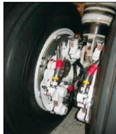
Slika 4. Električna zavora in njena namestitvev (proizvajalec Goodrich)
