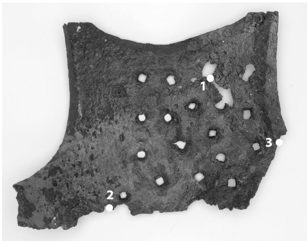
Figure 1: Fragment of breastplate showing the locations of the samples (Photo: T. Lazar), Goriški muzej, Nova Gorica, s. n. Slika 1: Odlomek prsne plošče z mesti odvzema vzorcev (foto: T. Lazar), Goriški muzej, Nova Gorica, s. n.
