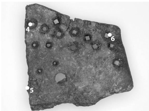
Figure 2: Fragment of steel plate showing the locations of the samples (Photo: T. Lazar), Goriški muzej, Nova Gorica, s. n. Slika 2: Odlomek jeklene plošče z mesti odvzema vzorcev (Photo: T. Lazar), Goriški muzej, Nova Gorica, s. n.
