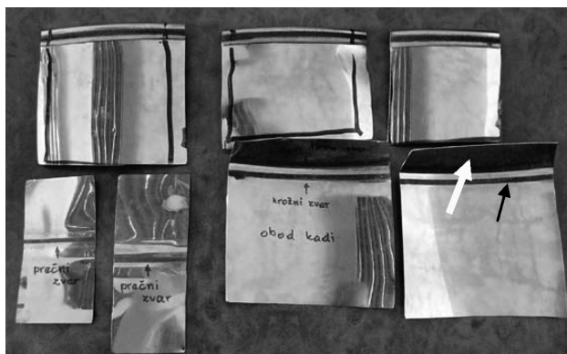
Slika 1: Vzorci s prečnim in krožnim zvarom. Jeklo X6Cr17. Svetla puščica označuje dno kadi, črna puščica pa krožni zvar.
