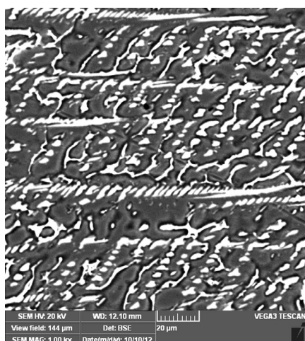
Figure 4: Microstructure of the as-cast Al-4Fe-4Cu-3Ni (SEM) Slika 4: Strjevalna struktura Al-4Fe-4Cu-3Ni (SEM)
