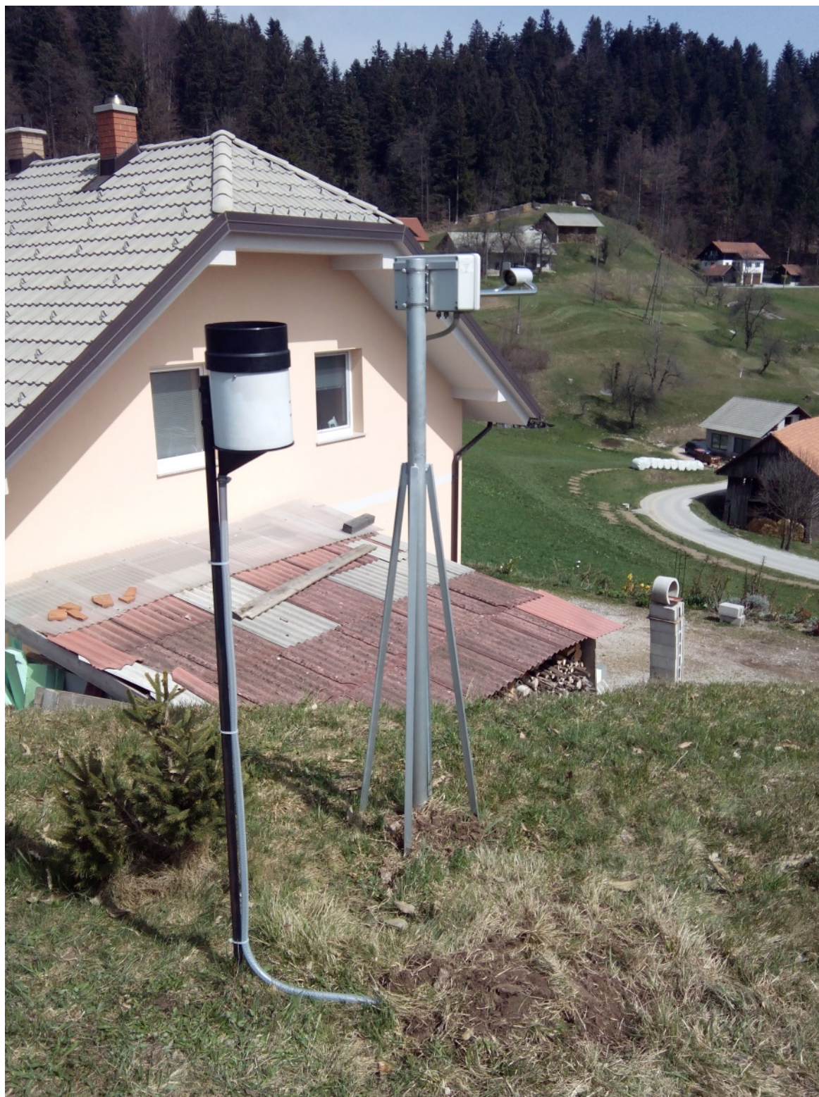
Slika 3: Optični disdrometer ter avtomatski dežemer, ki je hkrati tudi zbirna posoda za totalizator (zakopan pod zemljo) na Črnem vrhu nad Polhovim Gradcem.
