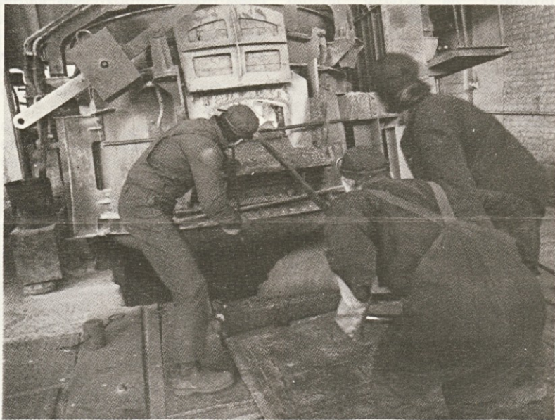
Ekipa talilcev pri mali tritonski elektroobločni peči v livarni jeklene litine pri delu. Mešanje litine je pomembno in težko opravilo talilcev (Foto: K.G.)
