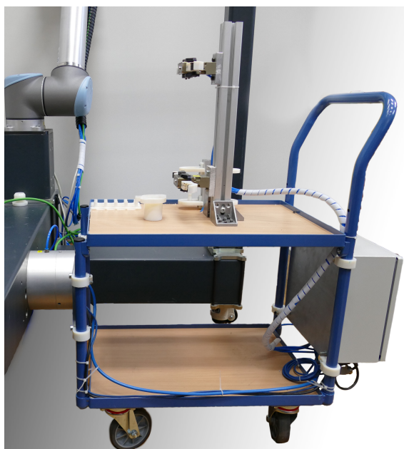
Slika 2: Vpenjalni modul za pogonski sklop motoriziranega pohištva.
