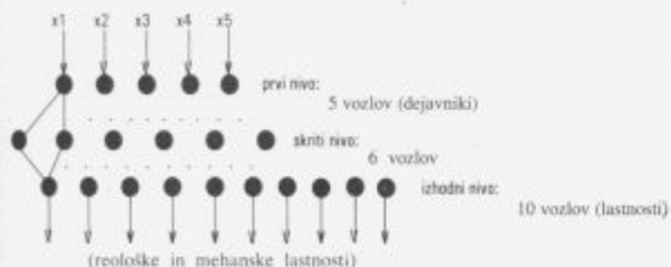
Slika 2: Arhitektura nevronske mreže je bila dvonivojska. Na prvem nivoju je bilo pet vozlov (5 dejavnikov oziroma vsebnosti komponent), na skritem nivoju je bilo šest vozlov in na zadnjem nivoju je bilo deset vozlov (10 merjenih lastnosti premaza). Uporabljen je bil algoritem z vzratnim popravljanjem napak
